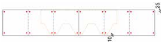
Рис. 12 Схема крепления коньково-карнизной черепицы Döcke PIE на карнизе.
