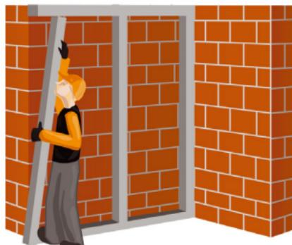
**Рис. 6.9. Установка стоечного профиля**
