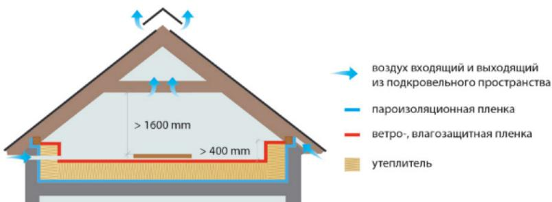
**Рис. 4.10. Устройство вентиляции холодного чердака**
