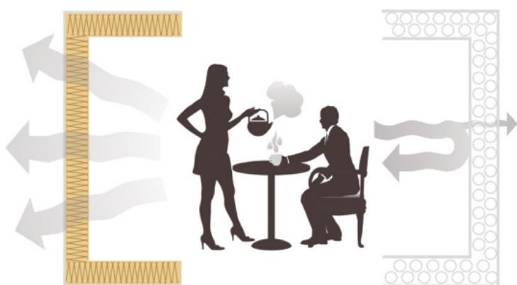
**Рис. 1.3. Сравнение утепленного каменной ватой и пенопластом помещений.**
