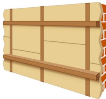
**Рис. 7.4. Установка горизонтального каркаса**
