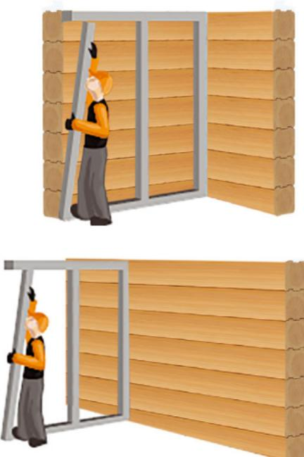
**Рис. 8.2. Установка каркаса под теплоизоляцию.**
