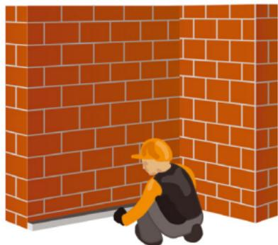
**Рис. 6.8. Установка направляющего профиля**
