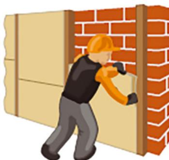
**Рис. 7.34. Укладка плит теплоизоляции первого ряда.**
