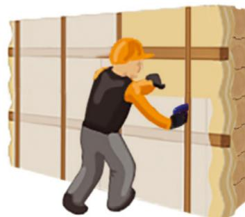
**Рис. 7.38. Монтаж контррейки.**
