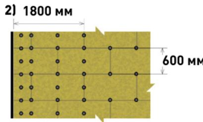
**Рис. 7.8. Схема установки связей 1) в основном поле стены, 2) угла здания в системе слоистой кладки**
