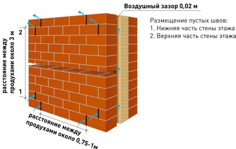
**Рис. 7.10. Обеспечение притока и оттока воздуха при помощи продухов в конструкции слоистой кладки**
