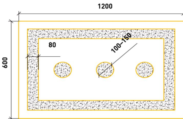
**Рис. 7.23. Схема нанесения клея контурно-маячковым способом**
