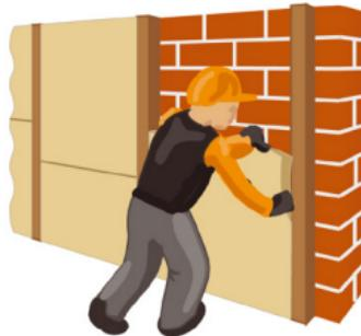
**Рис. 7.3. Монтаж теплоизоляционных плит в вертикальный каркас**
