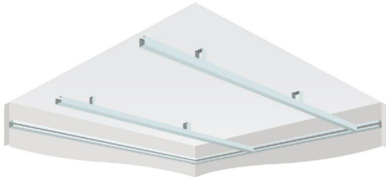
**Рис. 5.15. Установка подвесов и потолочного профиля**
