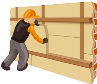
**Рис. 7.5. Монтаж теплоизоляционных плит в горизонтальный каркас**
