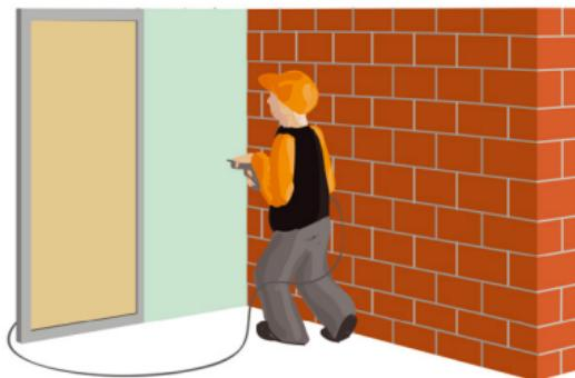
**Рис. 6.6. Обшивка второй стороны перегородки листами ГКЛ**
