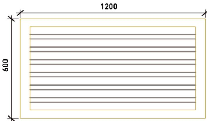
**Рис. 7.22. Схема нанесения клея сплошным методом**
