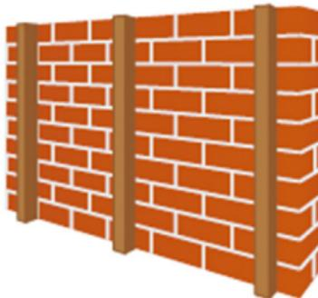
**Рис. 7.33. Установка вертикального каркаса под теплоизоляцию.**
