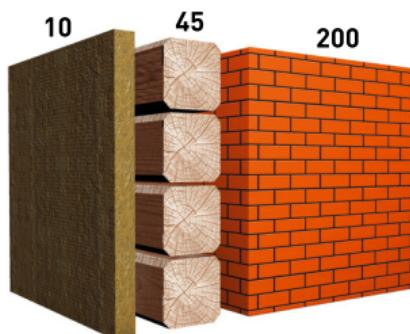
**Рис. 1.1. Сравнение материалов при одинаковой теплосберегающей способности**
