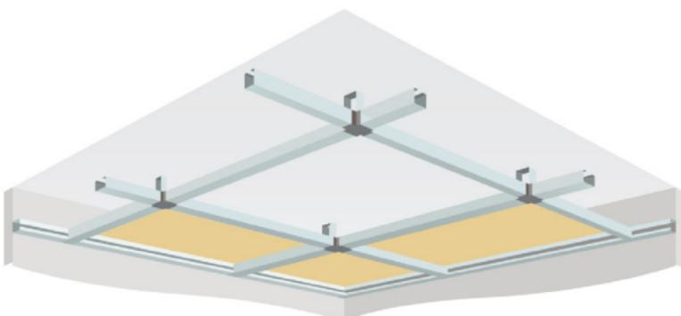
**Рис. 5.17. Укладка плит ТЕХНОАКУСТИК**
