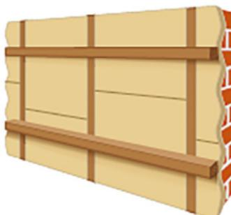
**Рис. 7.35. Установка горизонтального каркаса под теплоизоляцию.**
