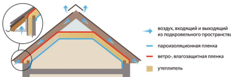
**Рис. 4.2. Устройство вентиляции мансарды**
