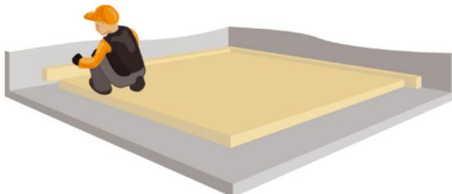
**Рис. 5.11. Укладка по периметру полос из звукоизоляционных плит ТЕХНОФЛОР СТАНДАРТ**
