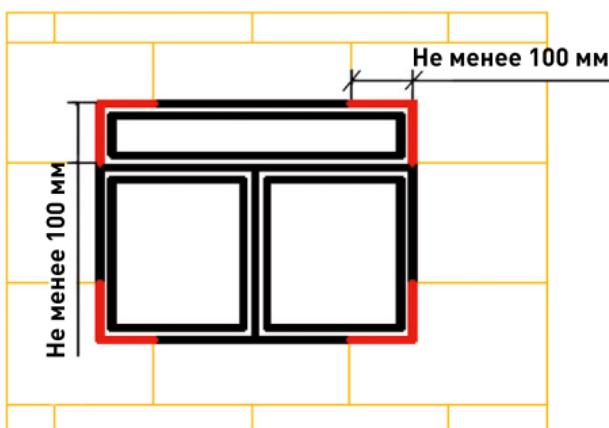
**Рис. 7.26. Укладка плит вокруг оконных и дверных проемов**
