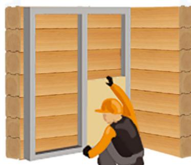
**Рис. 8.3. Укладка плит теплоизоляции.**
