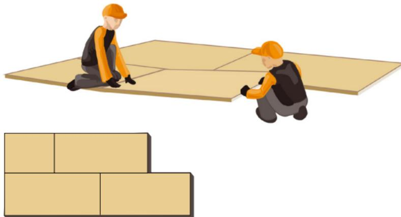
**Рис. 5.9. Процесс и схема укладки звукоизоляционных плит ТЕХНОФЛОР СТАНДАРТ**
