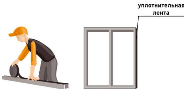
**Рис. 6.2. Приклейка и схема расположения уплотнительной ленты в каркасе**
