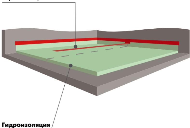
**Рис. 5.10. Схема укладки гидроизоляционного слоя**
