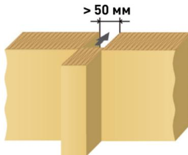
**Рис. 1.7. Плотное прилегание теплоизоляции при монтаже**
