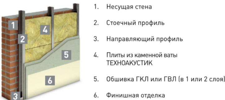
**Рис. 6.7. Система ТН-СТЕНА Стандарт**
