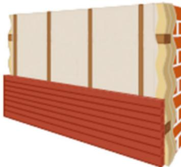
**Рис. 7.37. Устройство внутренней обшивки.**
