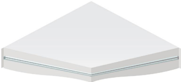
**Рис. 5.14. Установка направляющего профиля по периметру**
