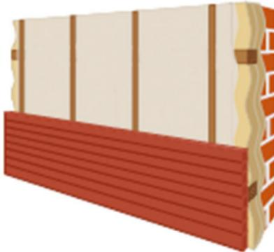
**Рис. 8.5. Устройство внутренней обшивки.**
