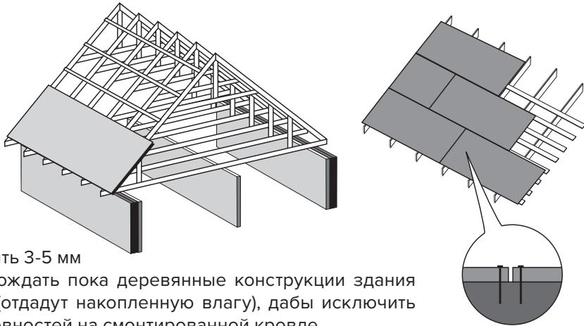
Зазор между плитами должен составлять 3-5 мм
