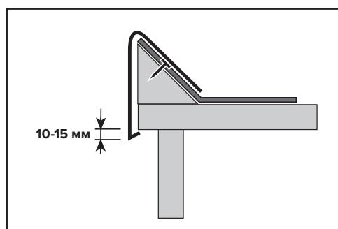
Для выполнения фронтонного свеса кровли с применением Рулонной черепицы ТЕХНОНИКОЛЬ необходимо обеспечить надежное крепление материала к поверхности. Для этого по всей длине свеса устраивается монтажный деревянный уголок на который в последующем будет осуществлено крепление материала и металлической планки.
