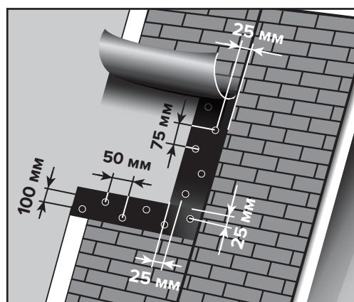
Следующий ряд Рулонной черепицы ТЕХНОНИКОЛЬ укладывается с боковым нахлестом 100 мм. Нижнее полотно материала прибивается к основанию кровельными гвоздями в разбежку с шагом 75 мм, предварительно удалив с перехлеста защитную пленку.
