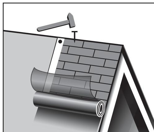
Перед началом монтажа необходимо очистить основание от мусора и пыли. Для улучшения адгезии материала рекомендуется обработать поверхность битумным праймером.
