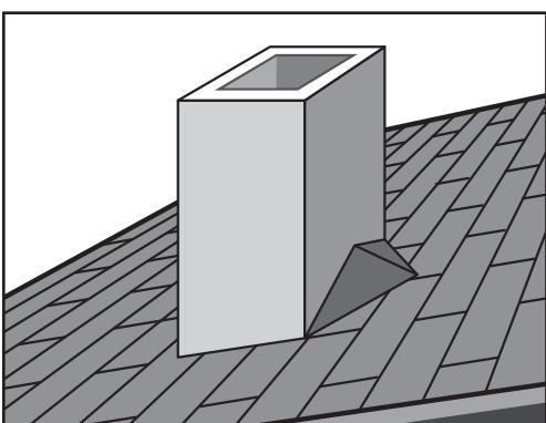
Для предотвращения скапливания снега за дымовыми и вентиляционными трубами, если их сечение превышает 500×500 мм и они расположены поперек ската, рекомендуется устанавливать разжелобок.
