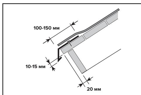
Карнизный свес кровли усиливается металлическими планками (капельниками). Они укладываются на край сплошного основания и крепятся специальными кровельными гвоздями в разбежку с шагом 120–150 мм, а в местах нахлестов 20–30 мм. Нахлест планок между собой составляет 30–50 мм.
