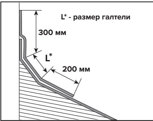
Для заведения на вертикальную поверхность используют Коньково-Ендовый ковер для Рулонной черепицы ТЕХНОНИКОЛЬ. Выкройки для заведения наверх следует укладывать внахлест не менее 200мм на поверхность покрытия и с минимальным нахлестом 300 мм на заводимую поверхность, дополнительно закрепив материал специализированными прижимными планками с шагом крепления 200 мм. Верхний стык планки герметизируется кровельным герметиком. Размер галтели уточняется по месту.
