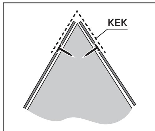
Аналогичным образом осуществляется монтаж второго ската кровли. Зона конька выполняется из Коньково-ендовного ковра ТехноНИКОЛЬ (KEK) согласно схемы устройства коньковых и реберных элементов.
